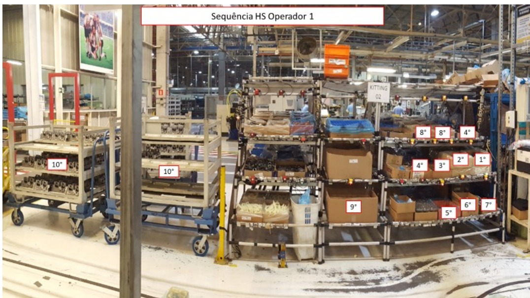
Figura 26 – Sequência de montagem operador 1 motor 1
