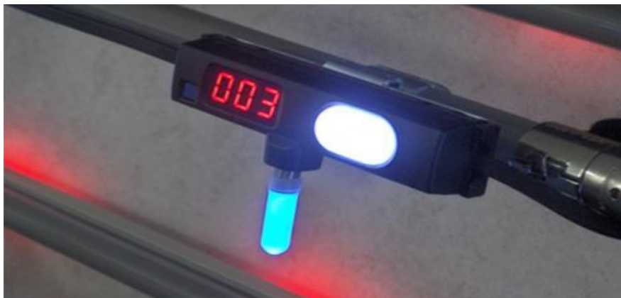
Figura 7 – Exemplo do processo “pick to light” com confirmação de quantidade
