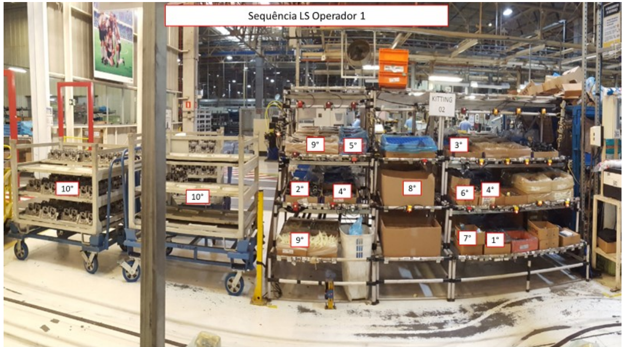
Figura 27 – Sequência de montagem operador 1 motor 2
