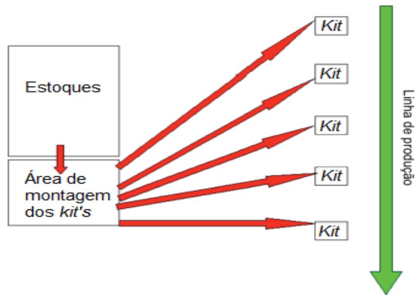
Figura 9 – Kitting com armazenamento centralizado picking
