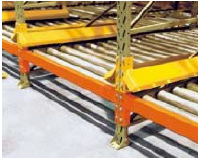
Figura 18 – Foto de um mecanismo de rolos no sistema de armazenagem dinâmico
