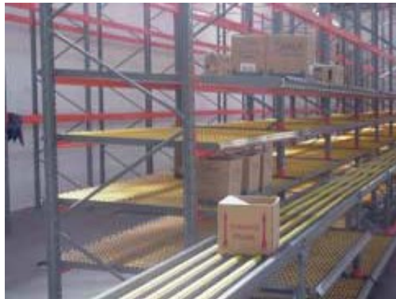
Figura 20 – Foto do sistema de armazenagem do tipo Flow-Rack
