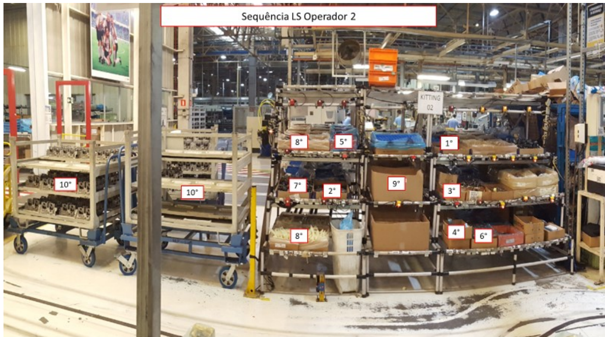
Figura 29 – Sequência de montagem operador 2 Motor 2
