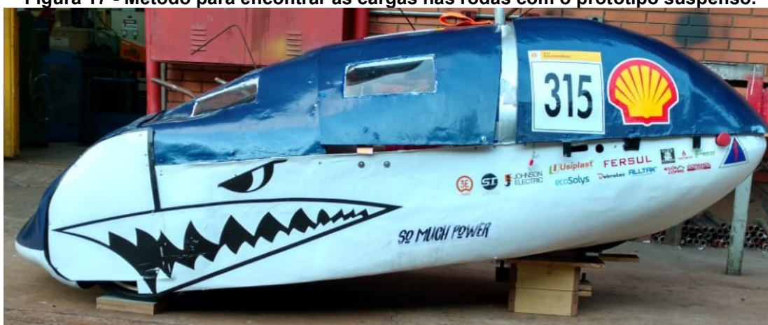
Figura 17 - Método para encontrar as cargas nas rodas com o protótipo suspenso.
