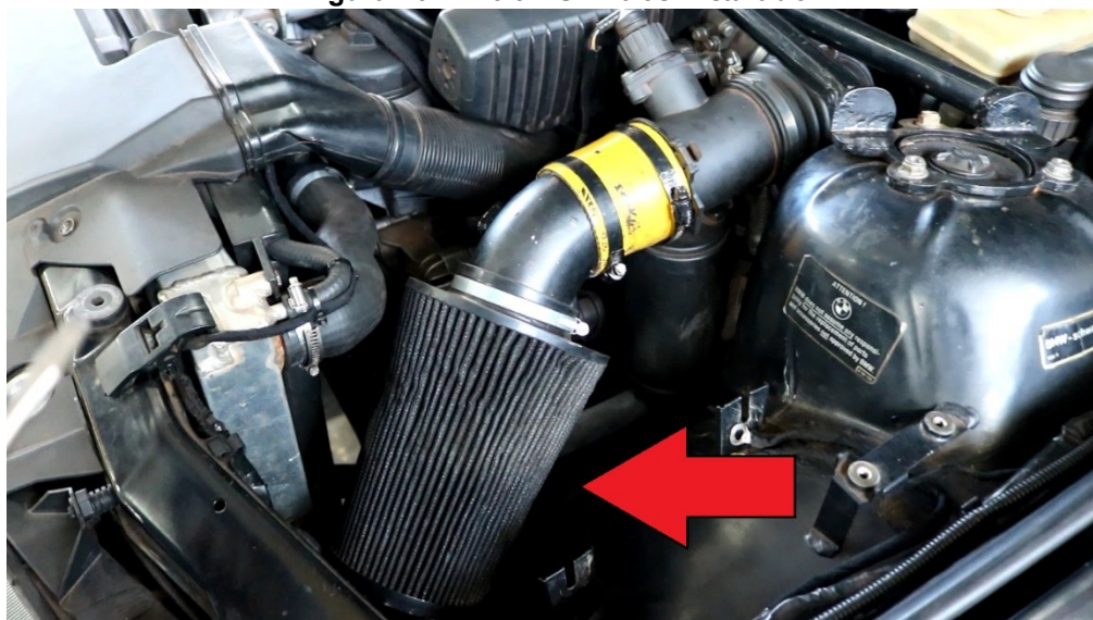
Figura 19 - Filtro RS Filtrros instalado
