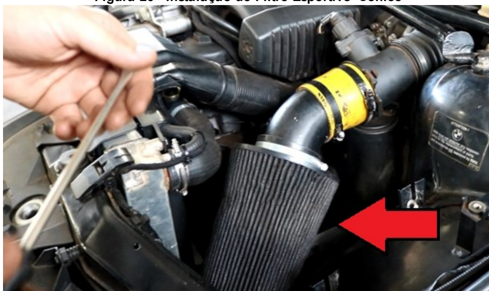
Figura 26 - Instalação do Filtro Esportivo Cônico
