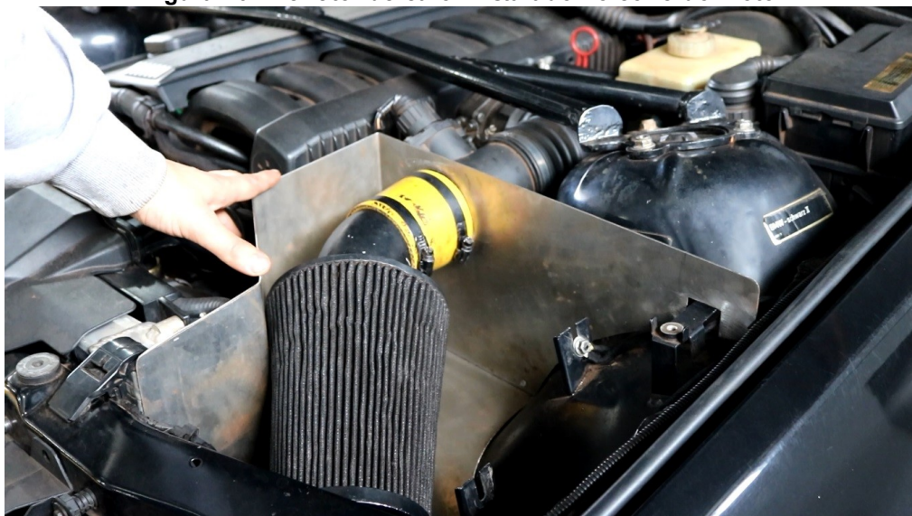
Figura 20 - Defletor de calor instalado no cofre do motor
