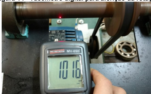
Figura 14 - Tacômetro digital para aferição da rotação
