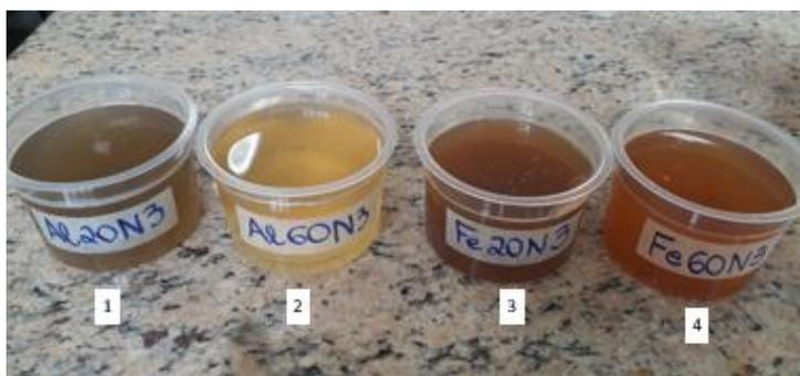
**Nota:** (1): indica o resultado da eletrocoagulação de 20 minutos em amostras dos Eletrodos de Alumínio; (2): indica o resultado da eletrocoagulação de 60 minutos em amostras dos Eletrodos de Alumínio; (3): indica o resultado da eletrocoagulação de 20 minutos em amostras dos Eletrodos de Ferro; (4): indica o resultado da eletrocoagulação de 60 minutos em amostras dos Eletrodos de Ferro. Fonte: O autor (2020).
