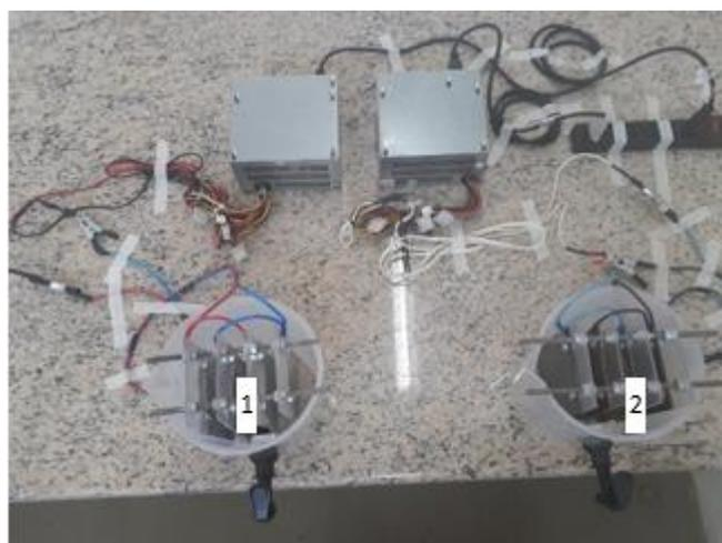
Nota: 1- Eletrodos de Alumínio; 2 Eletrodos de Ferro.
