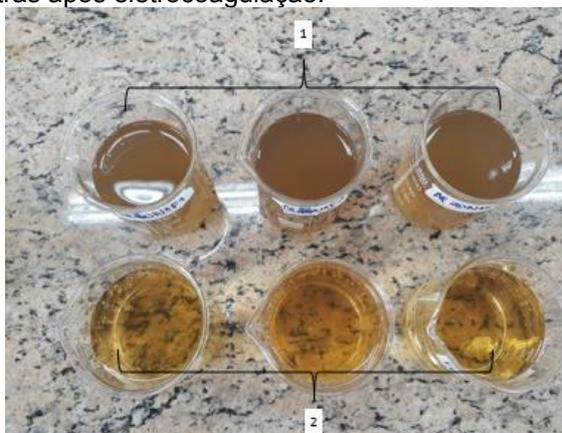
**Nota:** (1): indica o resultado eletrocoagulação dos Eletrodos de Alumínio; (2): indica o resultado eletrocoagulação dos Eletrodos de Ferro.
