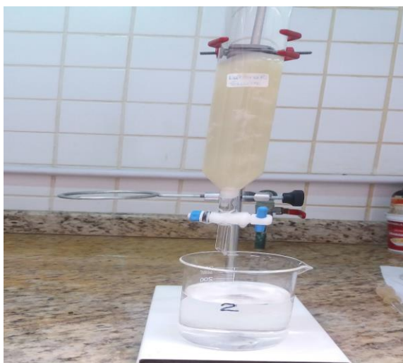
Figura 28- Coluna cromatográfica para purificação do eugenol Fonte: Próprio autor
