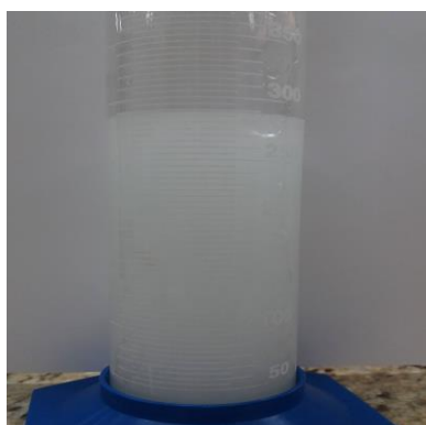
Figura 23- Hidrolato proveniente da hidrodestilação Fonte: Próprio autor
