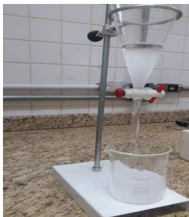
Figura 24- Destilado no funil de separação Fonte: Próprio autor
