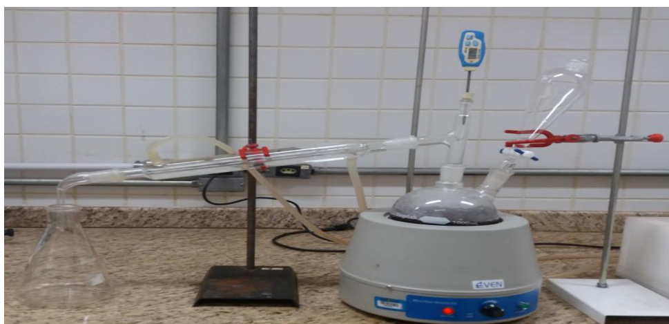
Figura 22- Aparelho para hidrodestilação Fonte: Próprio autor
