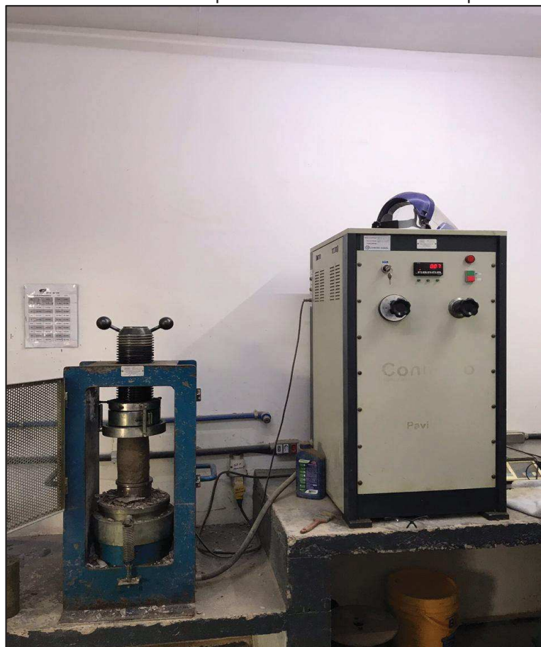
Figura 8 - Prensa hidráulica de compressão em laboratório da empresa de engenharia
