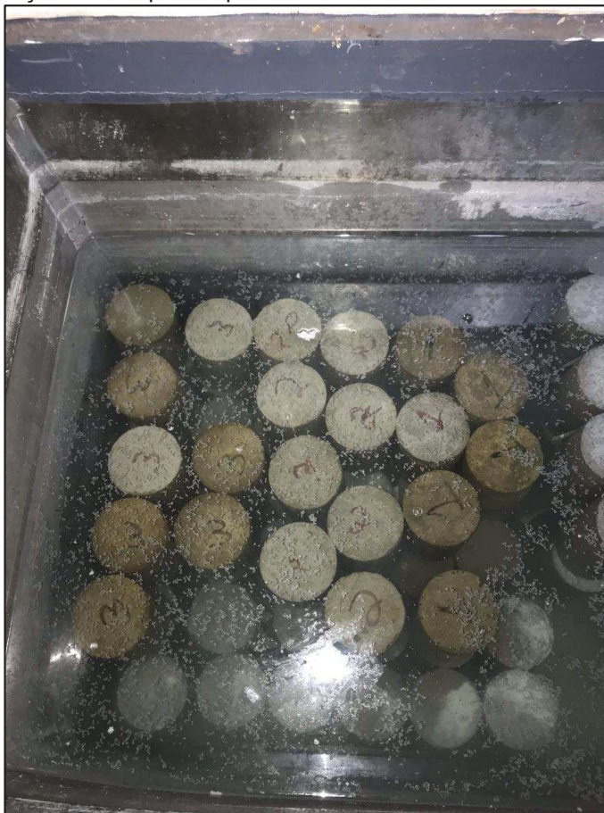
Figura 5 - Disposição dos corpos de prova de controle no interior do tanque de água e cal
