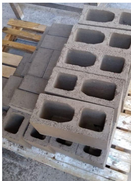
Figura 3. Blocos de concreto com utilização de escória de fornos de chumbo
