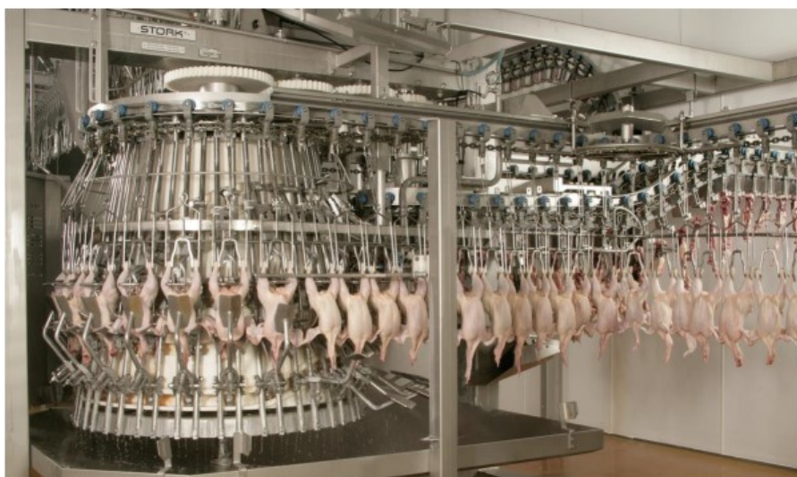
Figura 8 – Máquina automática de evisceração de frangos Fonte: Marel Poultry (2016).
