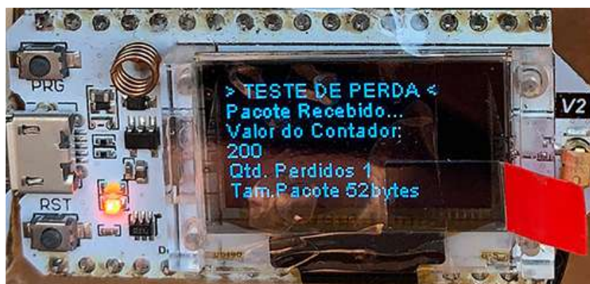
Figura 17 – Informações do display do receptor no teste de perda de dados
