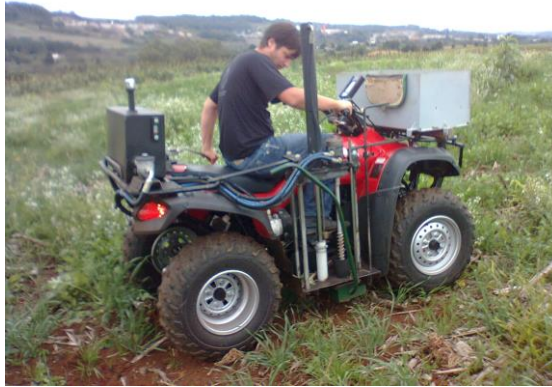
Figura 3 - Amostrador de solo acoplado ao quadriciclo da empresa AGRIPRECISÃO.
