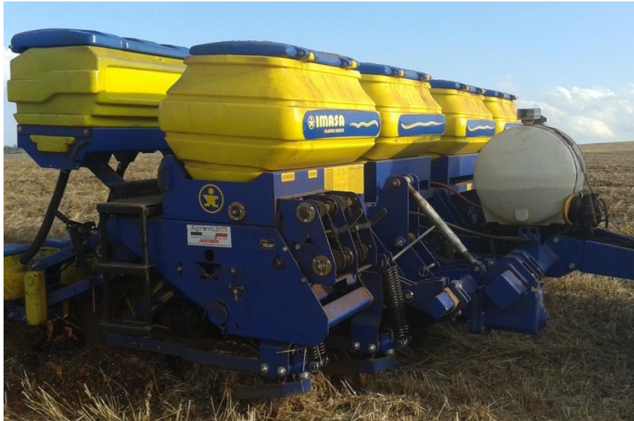
Figura 2: Semeadura de grãos graúdos equipada com sistema de pulverização MICRON. Renascença - PR, 2016.
