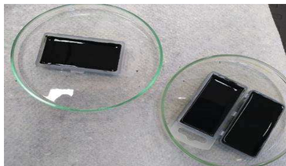
Figura 10 - Disposição das blendas no molde de plásticos antes de ir para secagem na estufa
