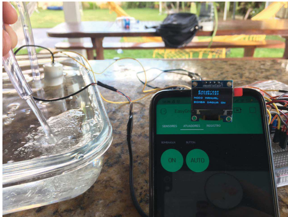
FIGURA 18 - SISTEMA APÓS PRESSIONAR NOVAMENTE O BOTÃO “ON/OFF” DO ATUADOR DA BOMBA D’ÁGUA.
