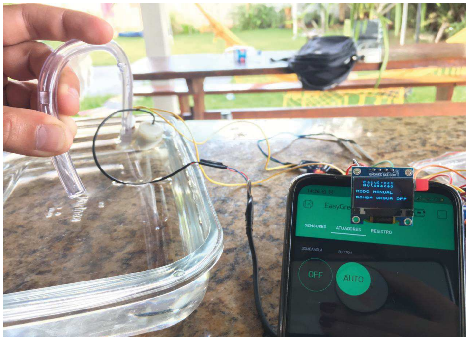
FIGURA 17 – SISTEMA APÓS PRESSIONAR O BOTÃO "ON/OFF" DO ATUADOR DA BOMBA D'ÁGUA.
