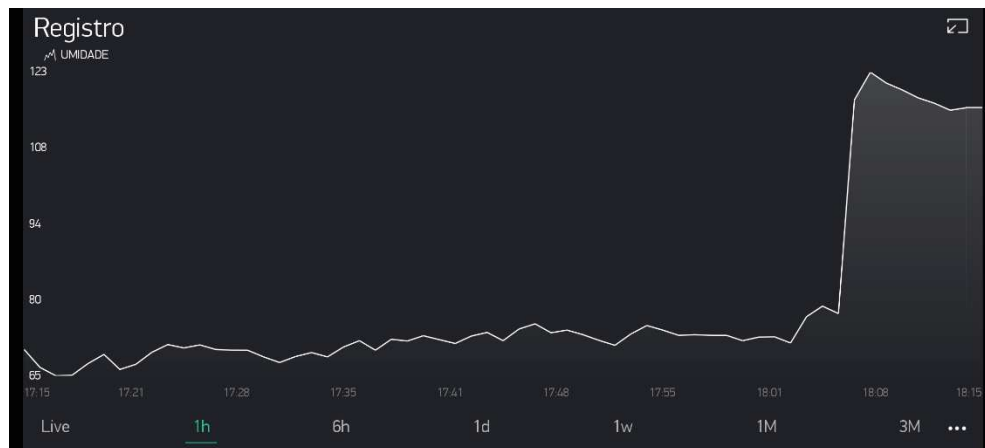
FIGURA 20 - GRÁFICO COM REGISTRO DE LEITURAS DO SENSOR YL-69 EM UM PERÍODO DE 1 HORA.
