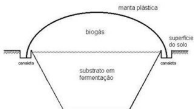
Figura 3 - Seção transversal do biodigestor modelo canadense
