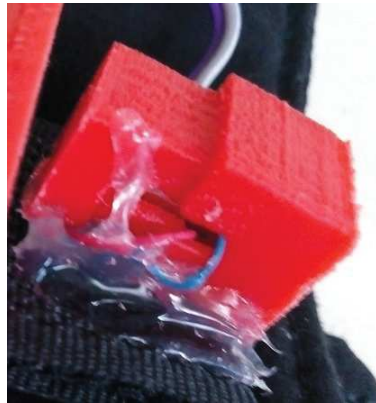
Figura 41: Motor de vibração instalado.
