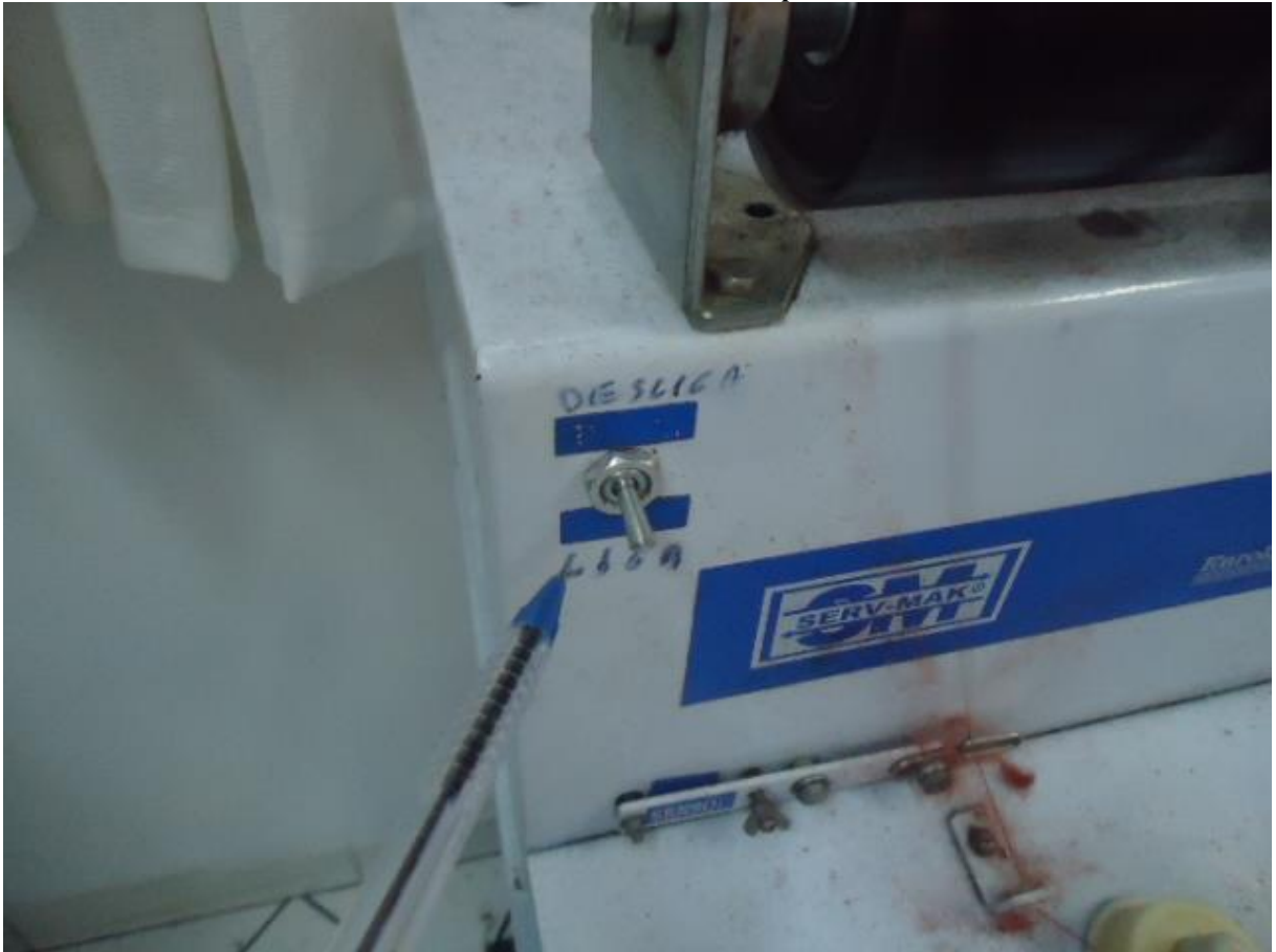
Figura 11 – Elemento de partida do enrolador desconforme Fonte – Autoria Própria
