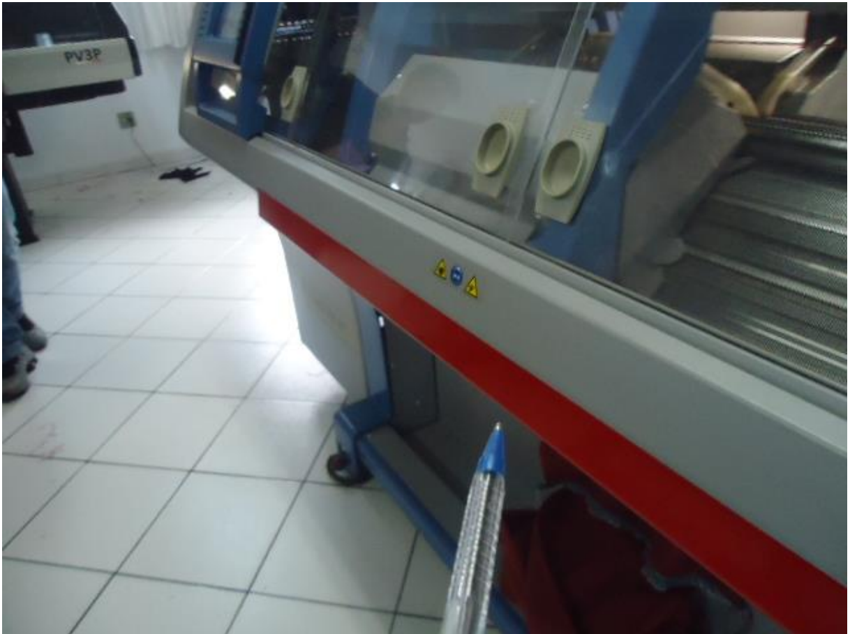
Figura 9 – Barra de acionamento e parada de emergência em teares eletrônicos
