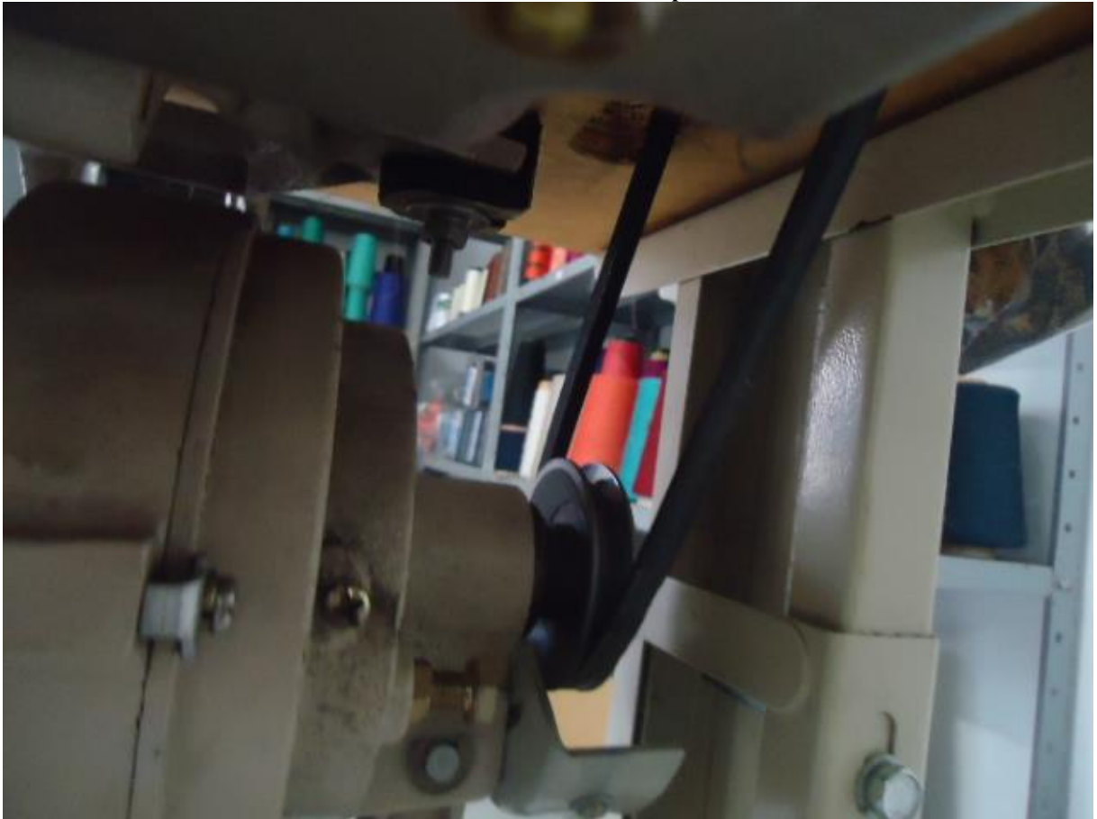
Figura 18 – Polias e correias expostas na máquina de costura reta Fonte – Autoria Própria
