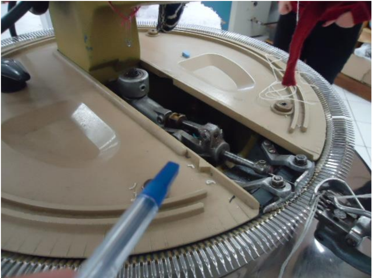
Figura 25 – Mecanismo de costura exposto em remalhadeira. Fonte – Autoria Própria
