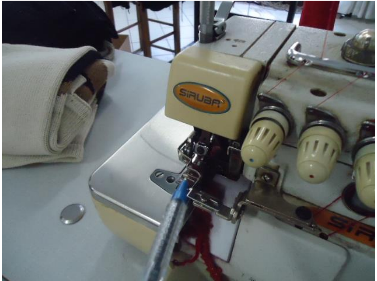
Figura 21 – Agulhas e facas desprotegidas Fonte – Autoria Própria
