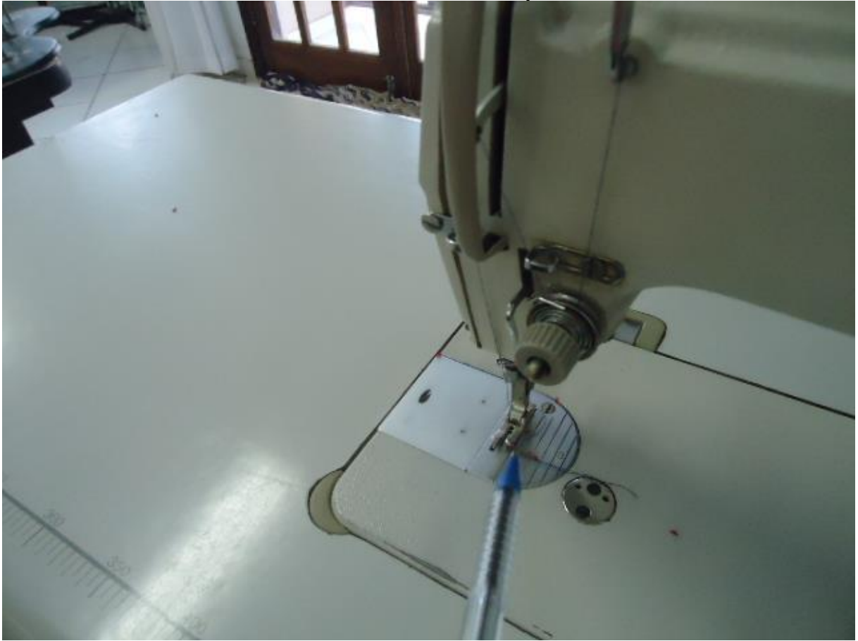
Figura 17 – Detalhe mostrando a agulha da máquina de costura reta desprotegida Fonte – Autoria Própria
