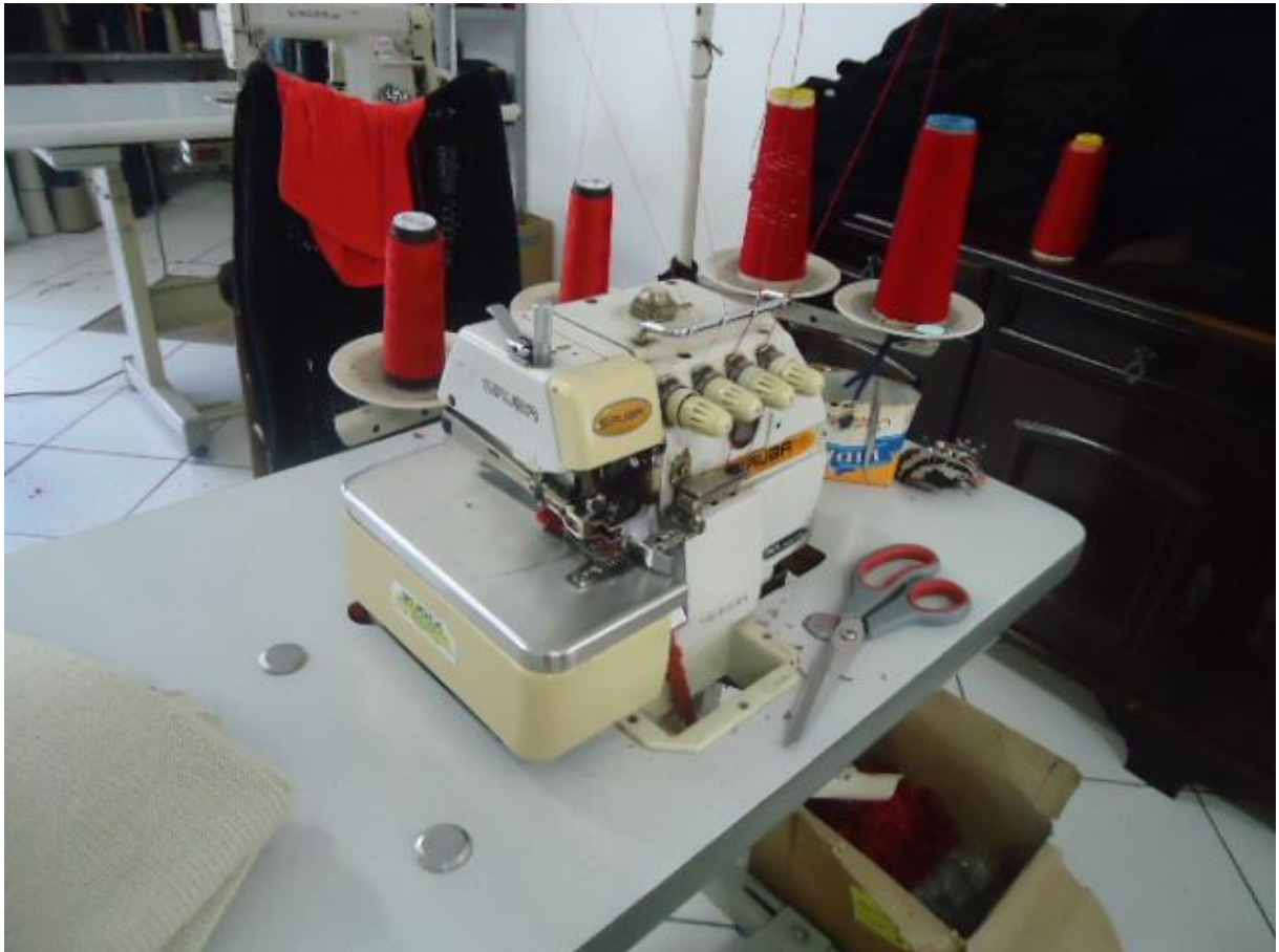
Figura 20 – Overloque utilizado em desconformidade com as normas. Fonte – Autoria Própria
