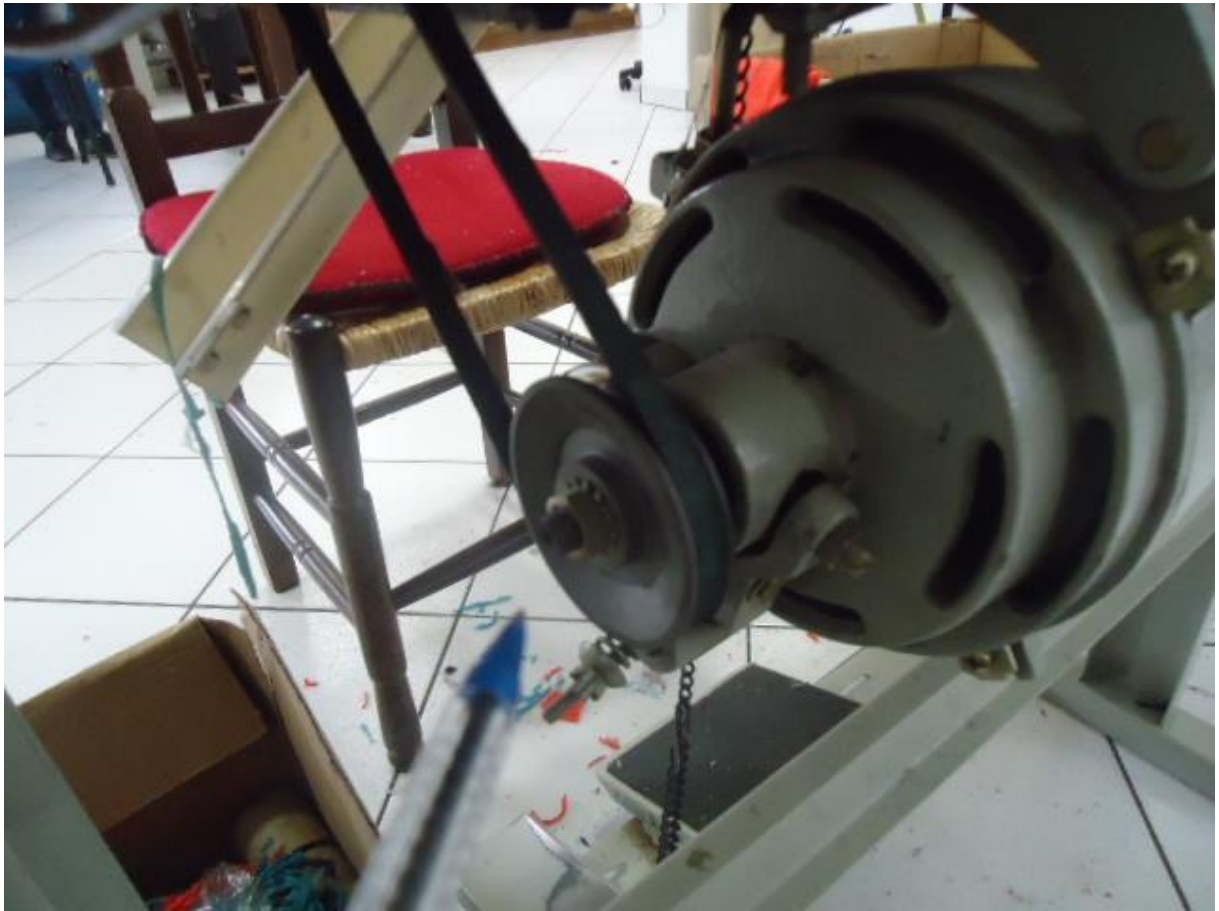
Figura 22 – Motor e correias de acionamento expostas Fonte – Autoria Própria
