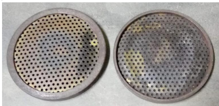
Figura 18 - Peneira inferior à esquerda e superior à direita para ensaio de permeabilidade
