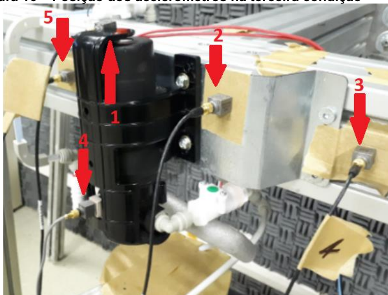
Figura 16 – Posição dos acelerômetros na terceira condição
