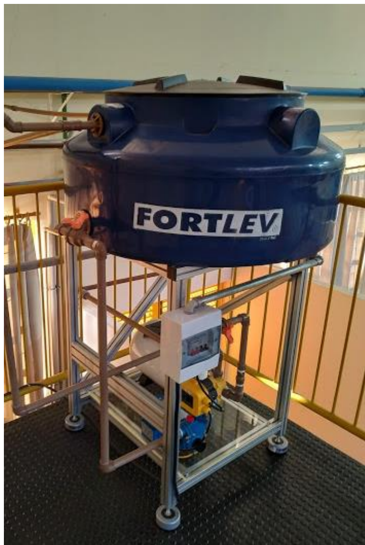
Fotografia 12 - Estrutura suporte do sistema
