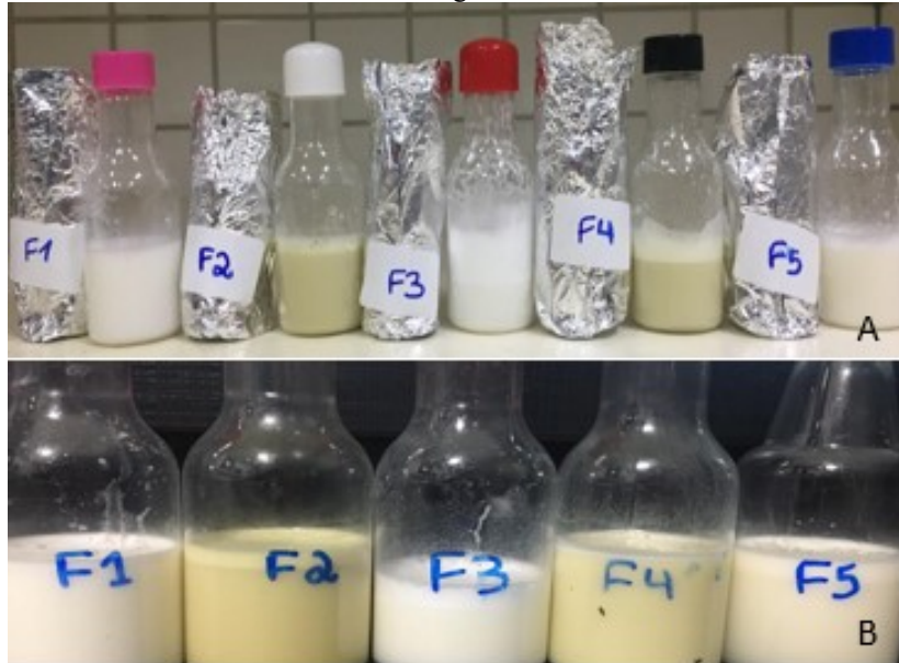
Figura 14 - Resultado do teste de aspecto e cor das emulsões F1 (controle), F2 (com 0,5% de PA-DCM), F3 (com antioxidante e antimicrobianos sintéticos), F4 (com 0,5% de PA-DCM e com antioxidantes sintéticos) e F5 (com antimicrobianos sintéticos e 0,05% de PA-DCM), no início e após o ciclo de gelo-degelo. A – Amostras antes de serem submetidas ao ciclo de gelo-degelo, B – Amostras após serem submetidas ao ciclo de gelo-degelo.
