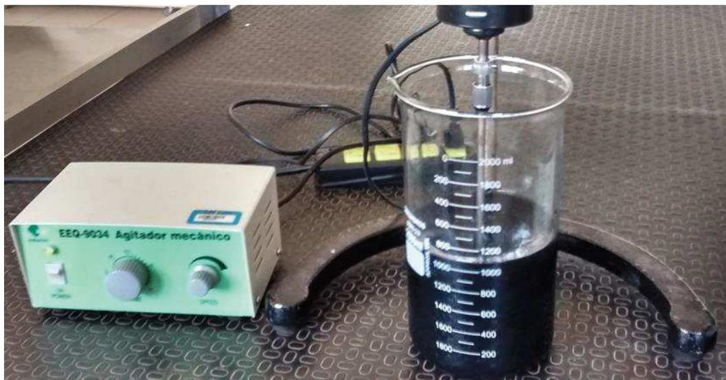
**Figura 4** – Aparato experimental para a impregnação do BMT.
