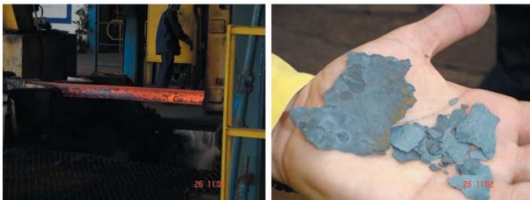
Figura 2 – Carepas na superfície do aço (esquerda). Carepas eliminadas do aço (direita).
