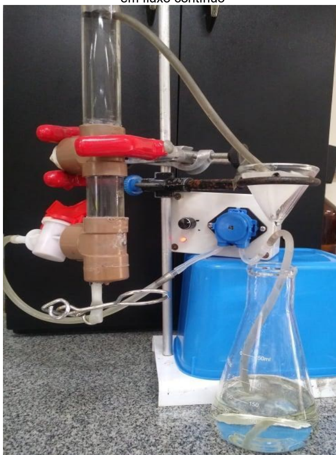
Figura 16 – Sistema de tratamento utilizado durante os tratamentos com reator de leito fixo operado em fluxo contínuo
