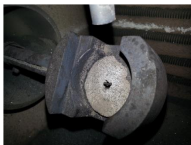
Figura 31 – Porta amostras detalhe termopar Fonte: Autoria própria.
