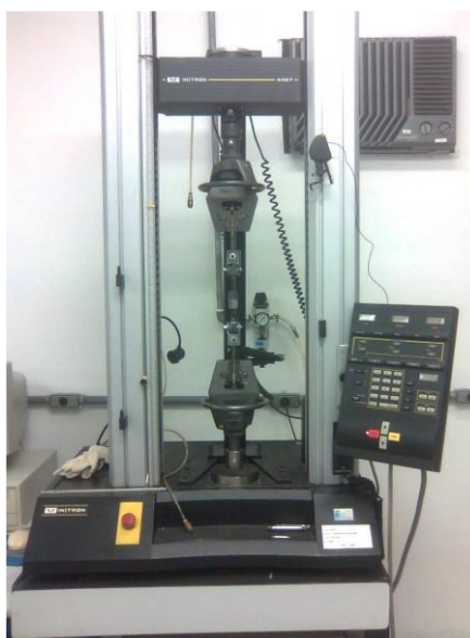
Figura 26 - Montagem do dispositivo de auto-alinhamento para ensaio de aderência no equipamento para tração. Fonte: Autoria própria.
