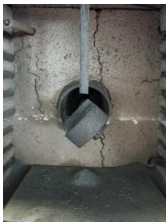
Figura 32 – Porta amostras detalhe ângulo de impacto na amostra. Fonte: Autoria própria.
