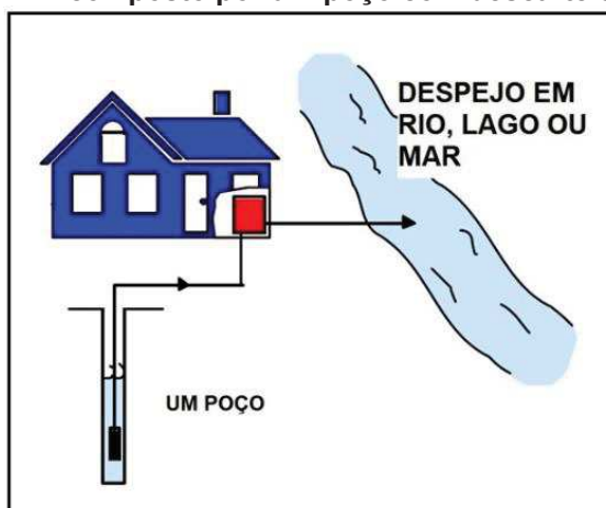
Figura 07 - Sistema GWHE composto por um poço com descarte em rios, lagos ou mares
