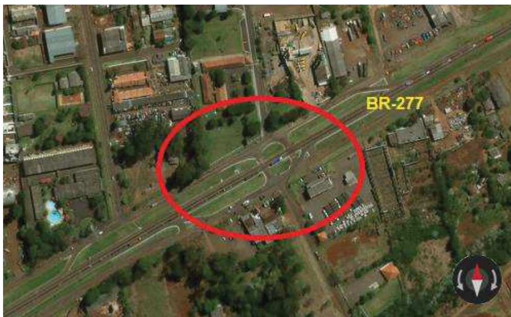
Figura 15 – Imagem de satélite destacando interseção em nível.
