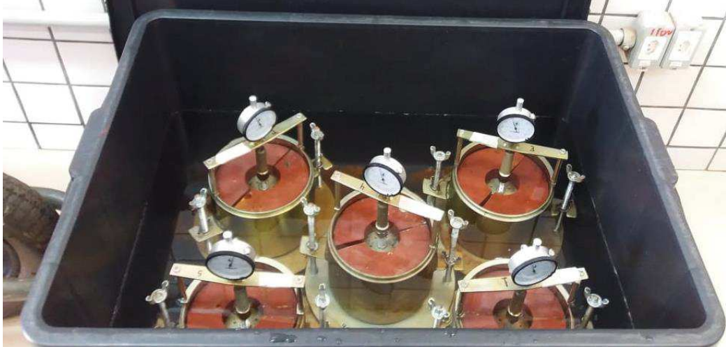
Figura 16 – Corpos de prova em imersão e com o extensômetro.
