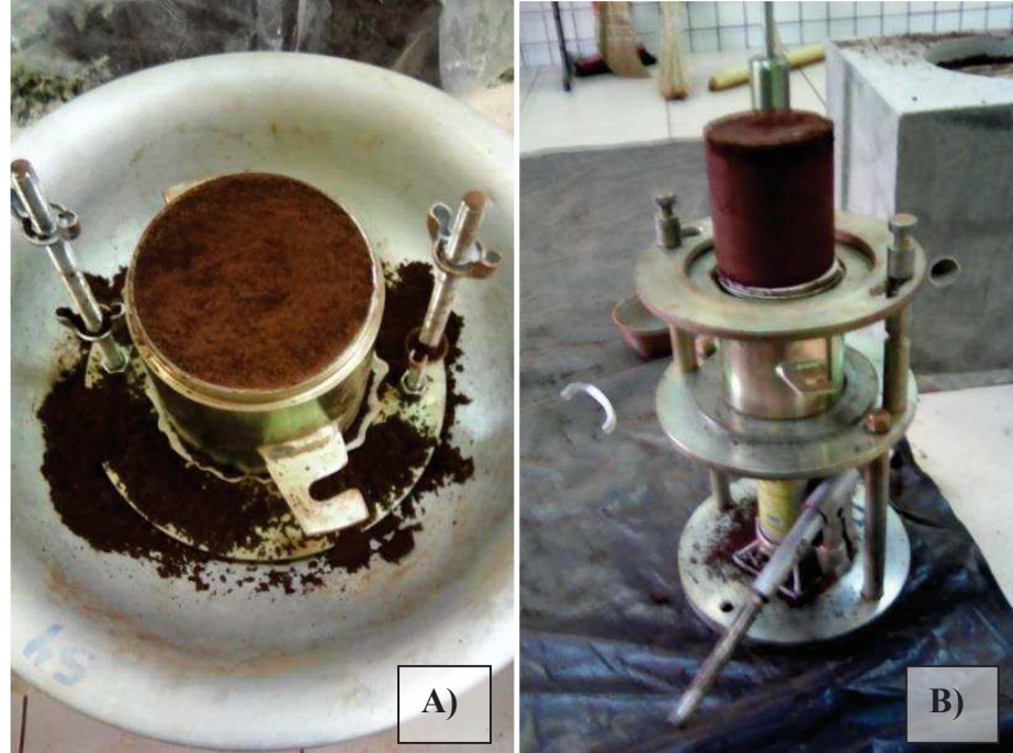
Figura 14 – (a) Corpo de prova após compactação; (b) Extração do corpo de prova.
