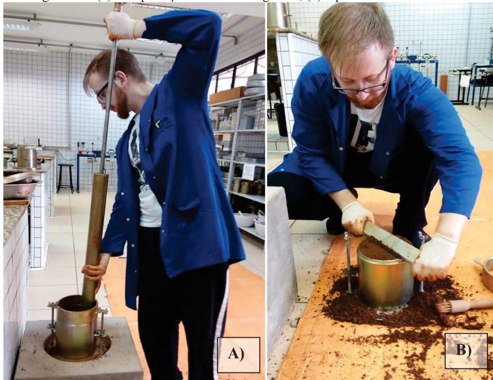
Figura 15 – (a) Compactação com cilindro grande; (b) Aplainamento da amostra.
