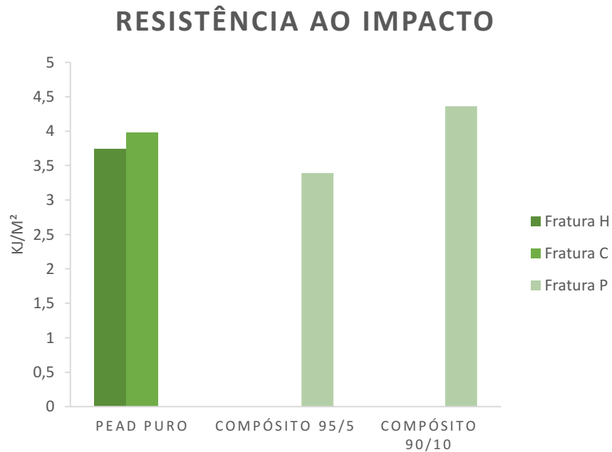
Figura 22 – Distribuição das energias de resistência ao impacto obtidas no ensaio
