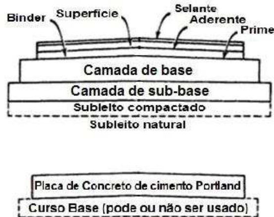
Figura 1 — Camadas constituintes dos pavimentos flexíveis e rígidos, respectivamente.
