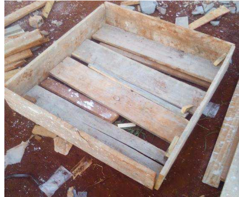
Figura 11 - Caixa utilizada para medir volume e suas respectivas dimensões.
