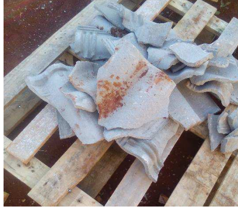
Figura 26 - Triagem para quantificação das telhas.
