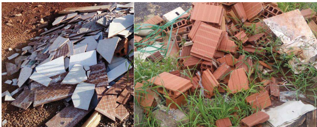
Figura 35 - Resíduos de cerâmica e tijolos acondicionado fora da baia.
