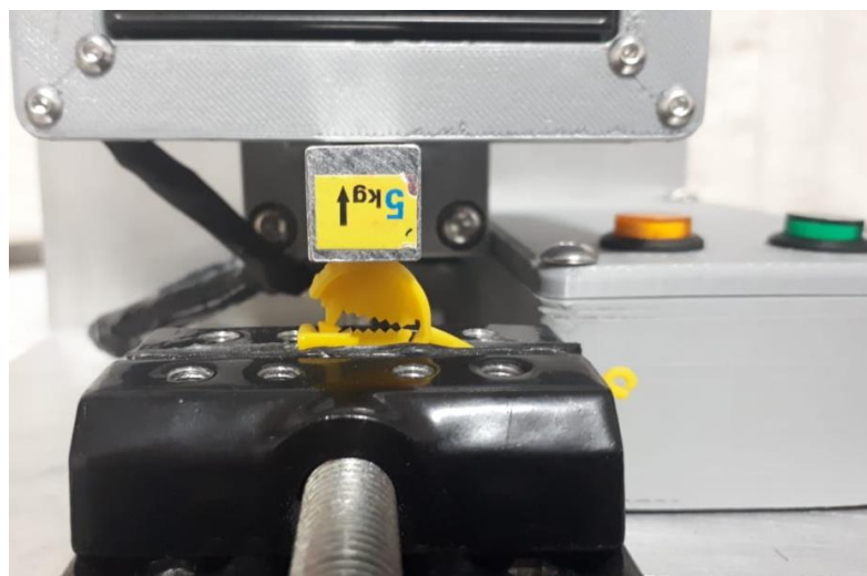
Figura 44 - Posicionamento do lacre plástico no dispositivo
