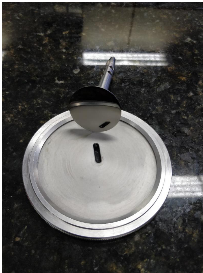
Figura 22 - Placa inferior com janela de vidro para passagem da luz e superior polida para refletir a luz.
