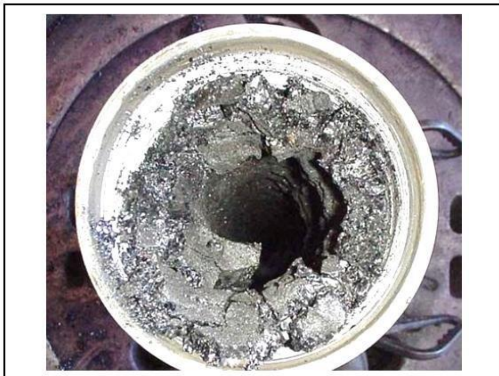
Figura 2 - Duto bloqueado pela deposição de parafina.
