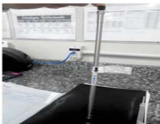
Figura 4 – Coluna cromatográfica utilizada no procedimento marca Akzo Nobel C-18.
