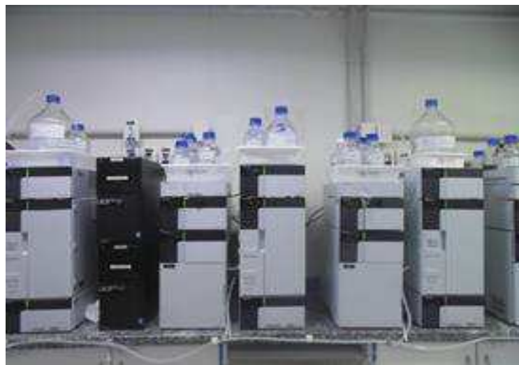
Figura 3 - Cromatógrafo Líquido com amostrador automático sem refrigeração modelo Shimadzu série 20.
