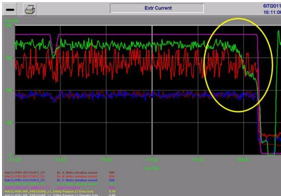
Figura 10: Gráfico no painel de controle no momento da queda da corrente Fonte: Autoria própria
