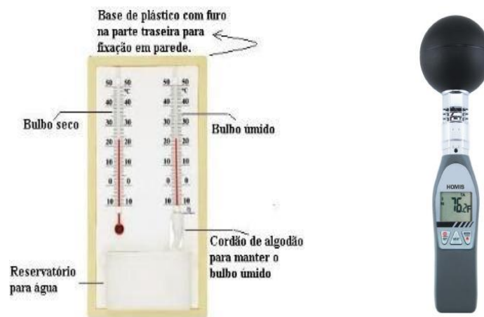
Figura 2 – Aparelho termohigrômetro analógico de bulbo seco e de bulbo úmido e termômetro digital de globo Fonte: Autoria própria
