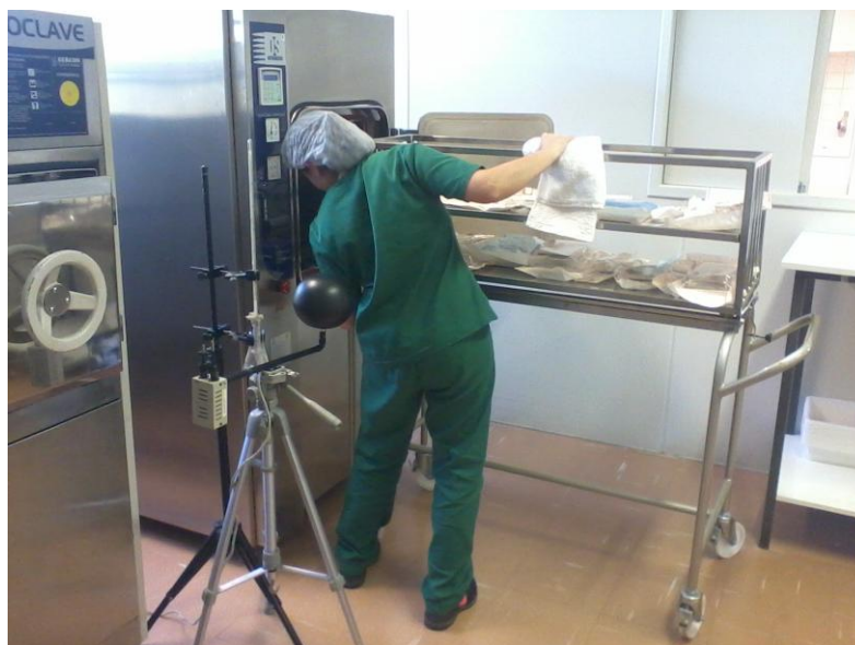
Fotografia 4 - Confortímetro Sensu® e árvore de IBUTG no local de medição Fonte: Autoria própria
