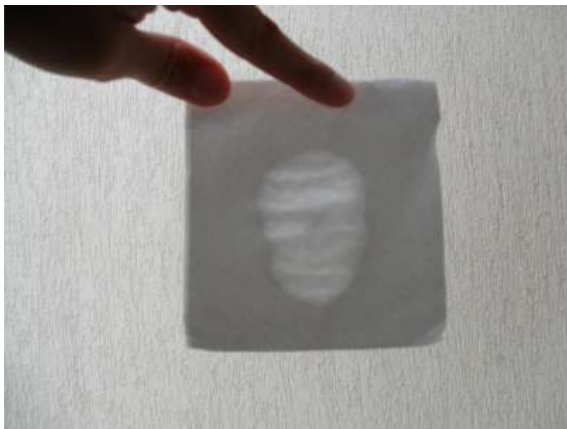
Foto 9 – Exemplo de padrão de molhamento do papel absorvente: grau 3 Fonte: Aatoria própria (2013).
