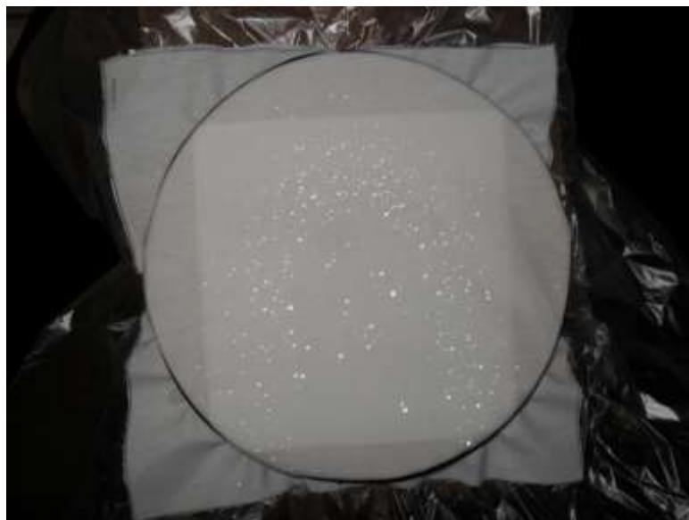
Foto 8 – Exemplo de padrão de molhamento obtido nos testes Fonte: Autoria própria (2013).
