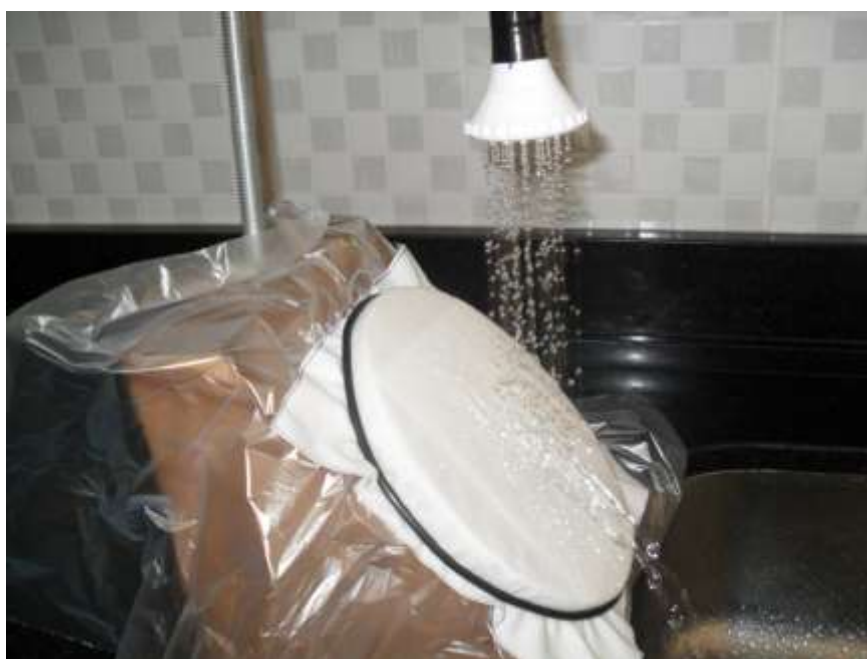
Foto 6 – Spray tester em utilização no experimento Fonte: Autoria própria (2013).
