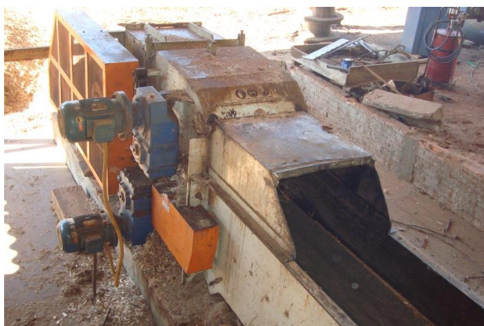
Foto 2 – picador de madeira a tambor fixo. Fonte: autor.
