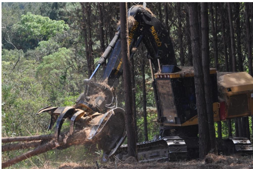
Fotografia 2 - Feller buncher Tigercat L870C Fonte: Klabin do Paraná (2007)
