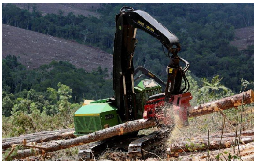
Fotografia 4 - Processador Harvester John Deere 903 Fonte: Klabin do Paraná (2014)
