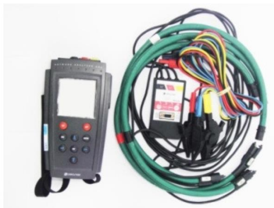
Figura 2 – Analisador Circutor modelo AR5 Fonte: Acxxus Engenharia de Medições
