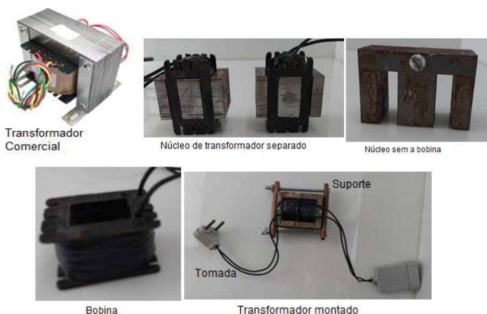
Figura 21: Processo de desmontagem e montagem de um transformador
