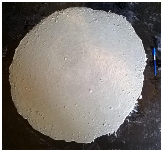
Figura 14 – Slump flow do concreto de controle Fonte: Autor, 2016.
