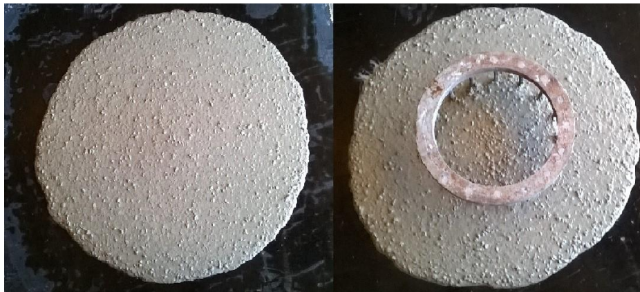
Figura 24 – Espalhamento da mistura C0 sem anel J (esquerda); com anel J (direita) Fonte: Autor, 2016.
