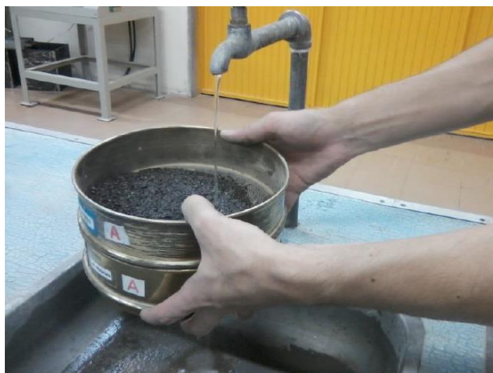
Figura 11 – Determinação do material pulverulento do agregado miúdo Fonte: Autor, 2016.
