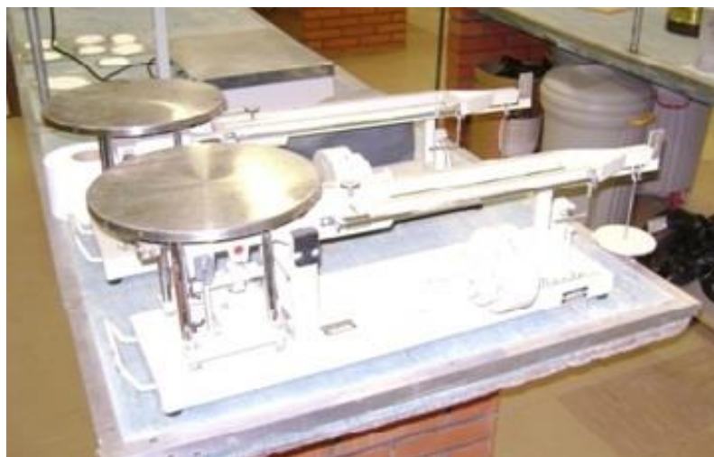
Figura 12 – Determinação da massa específica aparente da brita Fonte: Autor, 2016.
