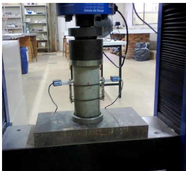
Figura 19 – Ensaio de módulo de elasticidade Fonte: Autor, 2016.
