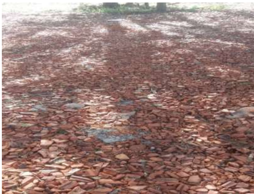
Figura 13: Agregados utilizados para tapar buracos. Fonte: Autoria própria (2018).
