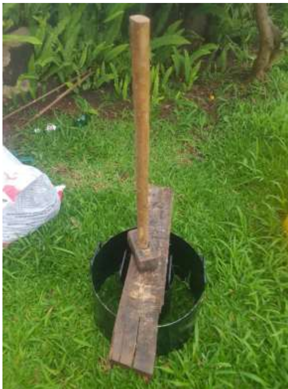
Figura 6: Infiltrômetro e Materiais Utilizados nos Ensaio Fonte: Autoria Própria.
