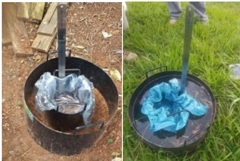
Figura 7: Infiltrômetros de Anel com Plástico e Régua Graduada, em Solo Exposto e Gramínea. Fonte: Autoria Própria.
