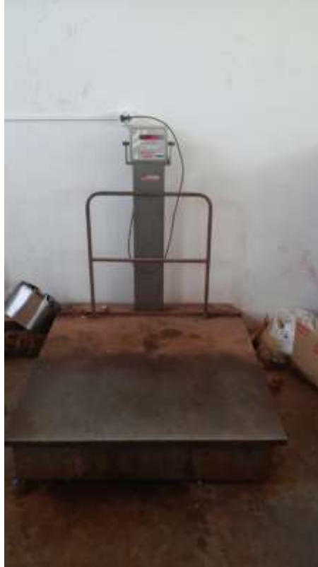
Figura 8 – Balança com Capacidade Para 300kg Fonte: Prefeitura Municipal de Cruzeiro do Oeste (2017)
