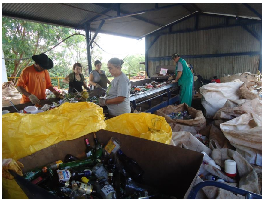
Figura 13 – Triagem dos resíduos sólidos
