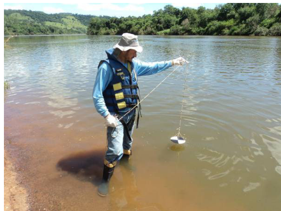
Determinação da transparência da água no ponto TJC (rio Chapecó) em 03/12/14.
