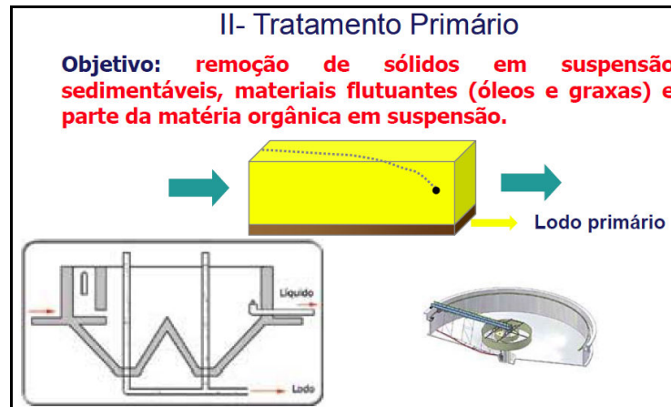
Figura 2: Tratamento primário Fonte: PINTO (2009)
