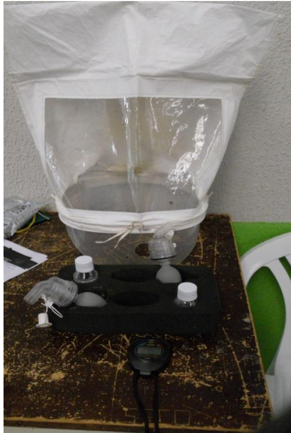
Figura 3 - Kit para realização do Fit Teste
