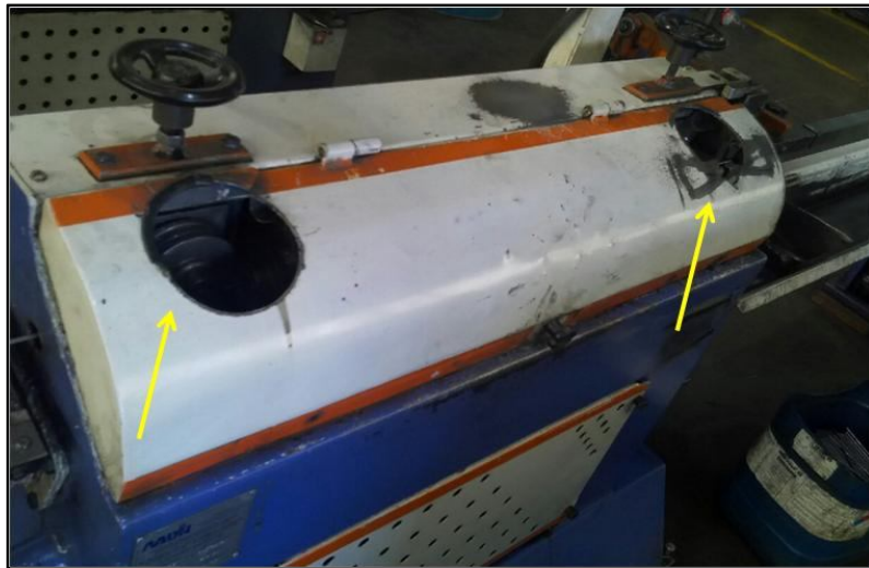
Figura 20 – Proteção mecânica móvel da máquina POL003. Fonte: O autor
