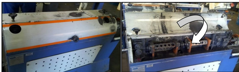
Figura 13 - Proteção mecânica móvel da máquina POL006.
