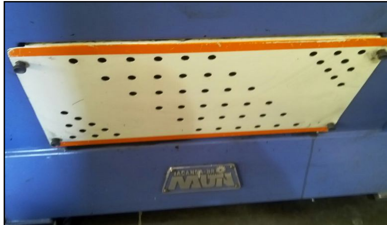
Figura 21 – Proteção mecânica fixa da máquina POL003.
